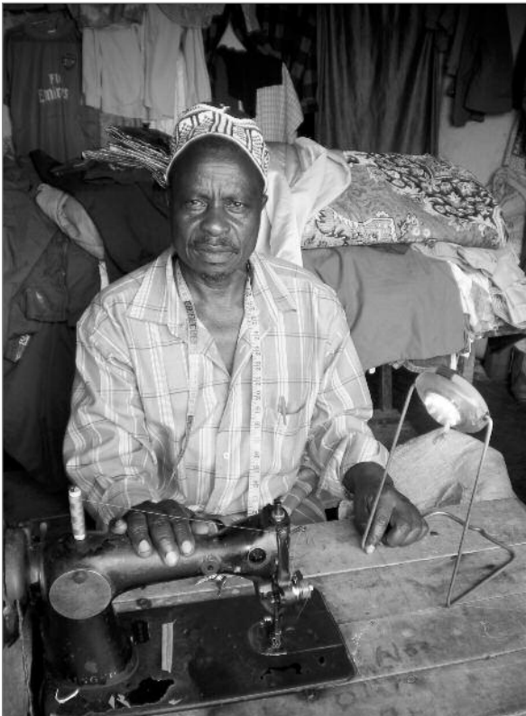
Foto 3: Die Nähmaschine wird mit dem Fuß angetrieben, das Licht liefert die Solarlampe
